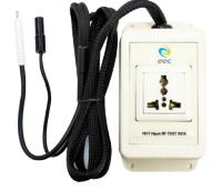
耐压绝缘测试治具盒 - 母端子
